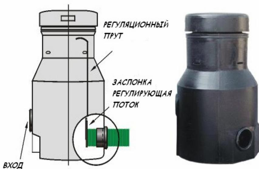
Распределительный колодец является началом дренажной системы и служит для равномерного отвода предварительно очищенных хозяйственно-бытовых отходов в трубопровод дренажной системы.
